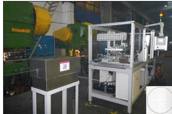
Кольцевой гибочный автомат модели RB 03 (WPF GmbH, Германия)
