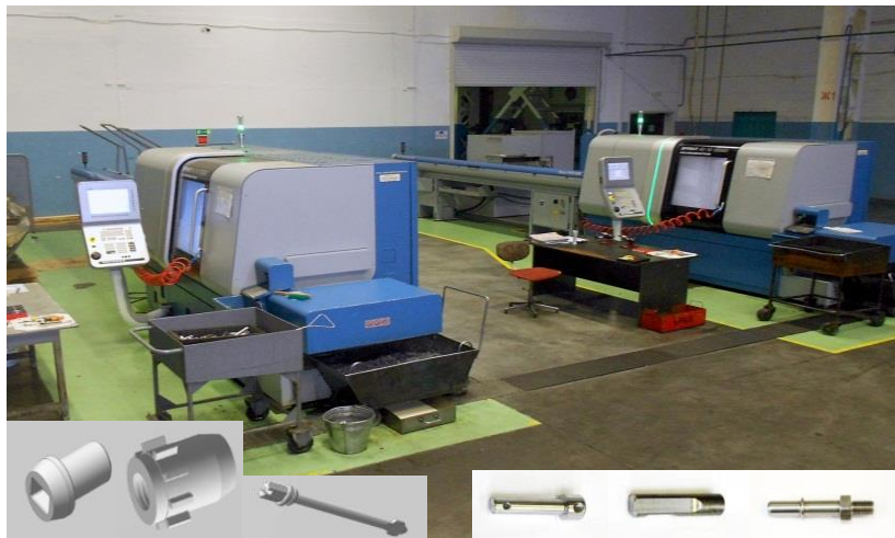
Два 4-х координатных токарных автомата Sprint 42/10 linear, ф. GILDEMEISTER
