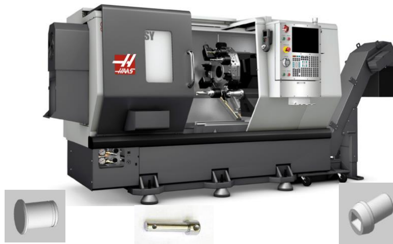
2-х координатный токарный центр HAAS ST-10
